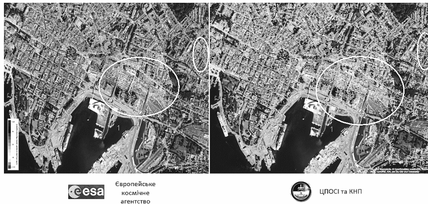
Рис. 12. Порівняльні інтерферометричні дослідження вертикальних зміщень залізничної станції у м. Осло. Виявлена швидкість просідання близько 15 мм. за рік
