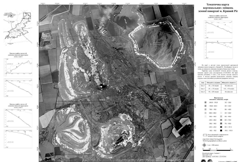
Рис. 8. Тематична карта інтерферометричних досліджень вертикальних зміщень і деформації земної поверхні у м. Кривий Ріг методом SBAS
