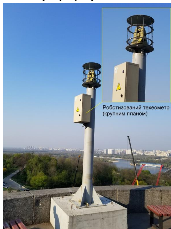
Рис. 2. Статичний пункт роботизованої тахеометрії «Парк Слави»
