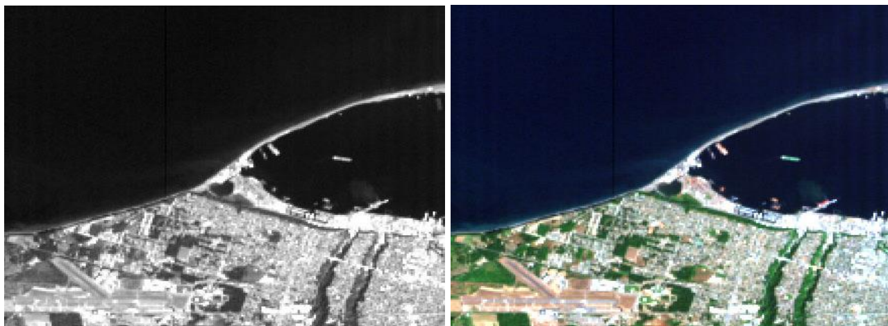
а) б) Рисунок 1 – Фрагмент гіперспектрального зображення EO-1/Hyperion порт Анжелес (Вашингтон, США), просторова розрізненність 30 м а) вхідне зображення б) зображення з виявленими компактними об'єктами
