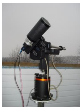
Рис. 1. Телескоп CST (зліва) та його приймач WAT-902H
