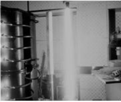
Рис.1. Фотореєстрація розряду штучної блискавки (а), та МПК (б)
