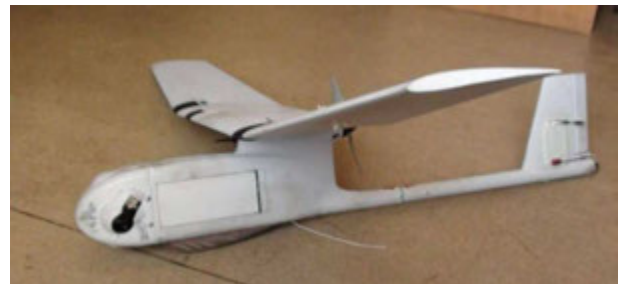
Рис. 1. – «Ручний Ворон», БпЛА ЗС України RQ-11B «Raven»
