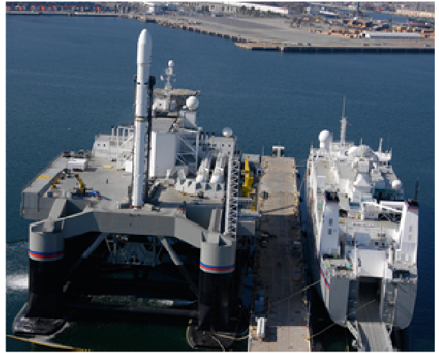
Рис. 2 – Морський сегмент: СКС Sea Launch Commander та стартова платформа Odyssey
