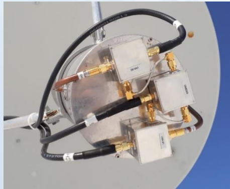
Dual circular pol. 'warm' front-end
